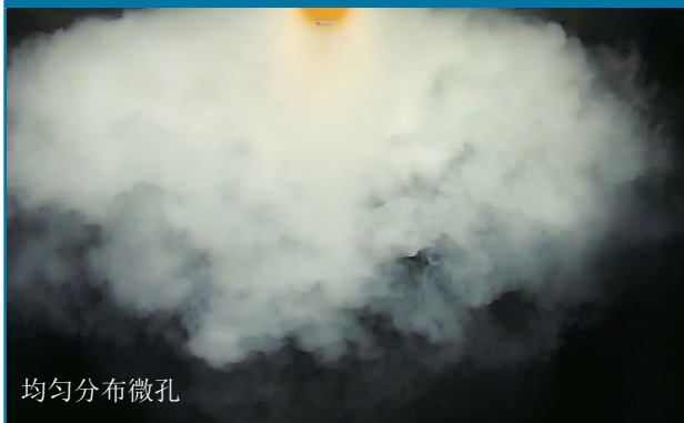
PRIHODA研发中心进行的烟雾测试，模拟各种送风模式的实景
