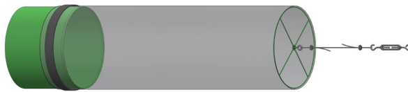
沿轴线方向把织物风管固定在侧墙上
