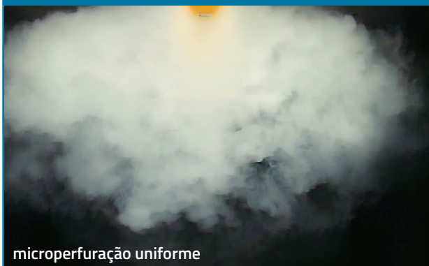
Exemplos de padrões de fluxo de ar criados usando testes de fumo no centro de I&D da PRIHODA
