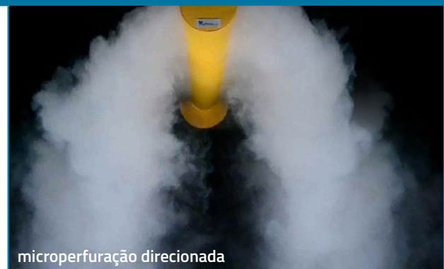
Exemplos de padrões de fluxo de ar criados usando testes de fumo no centro de I&D da PRIHODA
