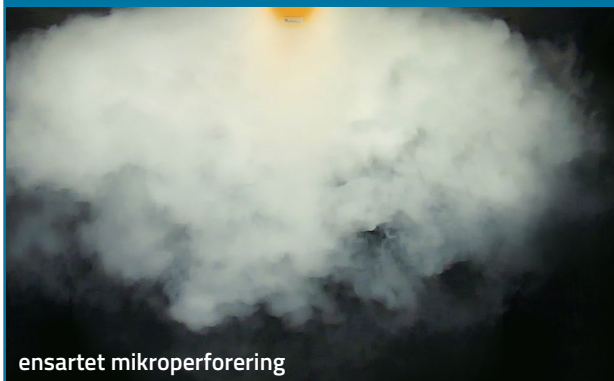
Eksempler på røgprøver foretaget i PRIHODA's udviklingscenter
