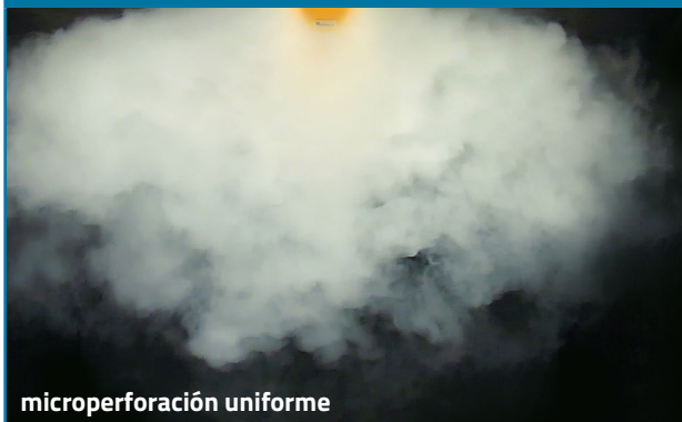
Ejemplos de patrones de flujo de aire creados mediante pruebas de humo en el centro de I+D de PRIHODA
