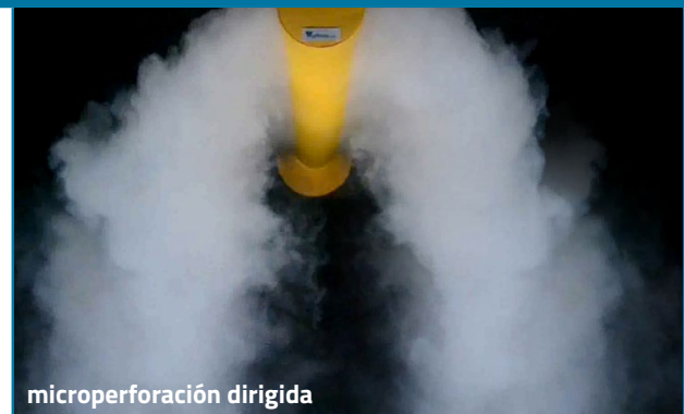
Ejemplos de patrones de flujo de aire creados mediante pruebas de humo en el centro de I+D de PRIHODA
