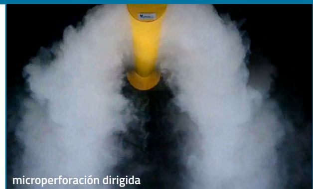
Ejemplos de flujo de aire creados usando pruebas de humo en el centro R&D de PRIHODA
