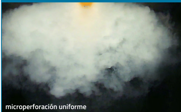
Ejemplos de flujo de aire creados usando pruebas de humo en el centro R&D de PRIHODA
