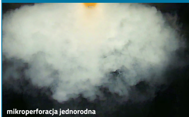
Przykłady schematów przepływu powietrza opracowanych przy użyciu testów dymnych w centrum badawczo-rozwojowym PRIHODA
