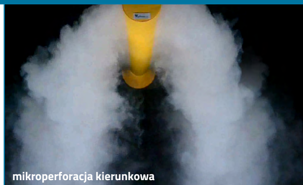
Przykłady schematów przepływu powietrza opracowanych przy użyciu testów dymnych w centrum badawczo-rozwojowym PRIHODA
