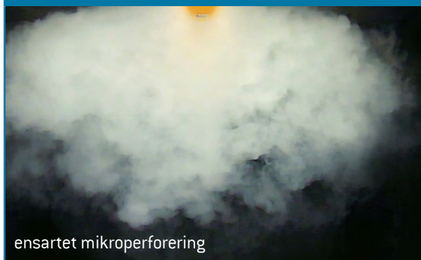
Eksempler på røgprøver foretaget i PRIHODA's udviklingscenter
