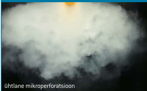
Näited suitsukatsetega loodud õhuvoolu mustritest, mis on läbi viidud PRIHODA teadus- ja arenduskeskuses
