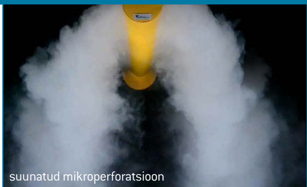
Näited suitsukatsetega loodud õhuvoolu mustritest, mis on läbi viidud PRIHODA teadus- ja arenduskeskuses
