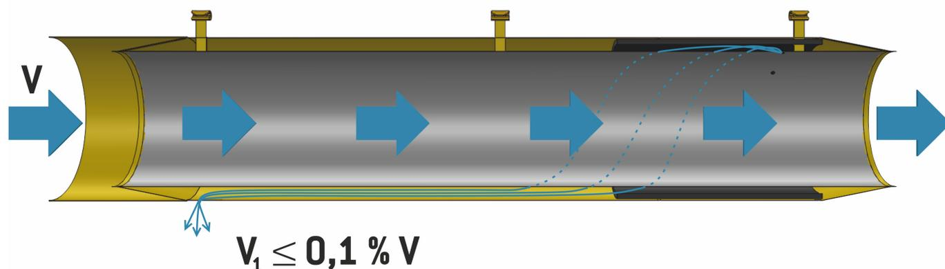
La condensa può essere evitata con l'utilizzo del doppio condotto. Lo strato interno è mantenuto in posizione corretta grazie ad un flusso d'aria minimo (circa l'1% del flusso interno al condotto). Questa piccola quantità di aria fluisce attraverso i fori sullo strato interno di tessuto nello strato intermedio, circolando e fuoriuscendo attraverso i fori sullo strato esterno.
